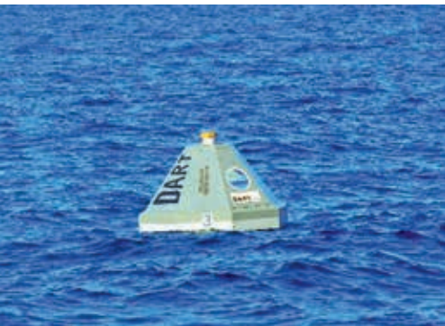
XXXVII pav. 600 m gilyje prie dugno pritvirtintos jūrinės bujos, kuriomis nustatomos artėjančias cunamio bangos (JAV Geologijos tarnybos (USGS) nuotrauka)
